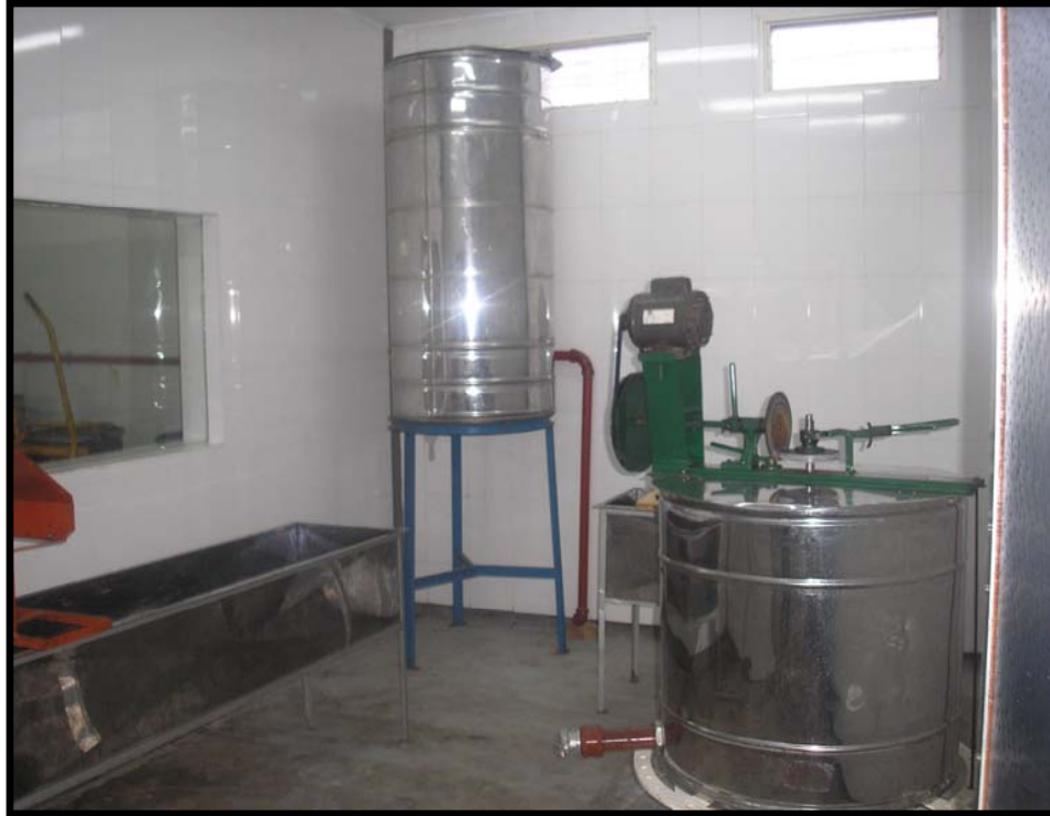
Centrifugadora. Permite separar la miel de la cera
